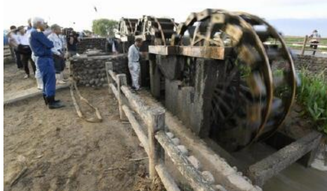
用水路に残った土砂や流木が取り除かれ、水が通された。水車は約1カ月ぶりに元のように動き始めた。8月2日
